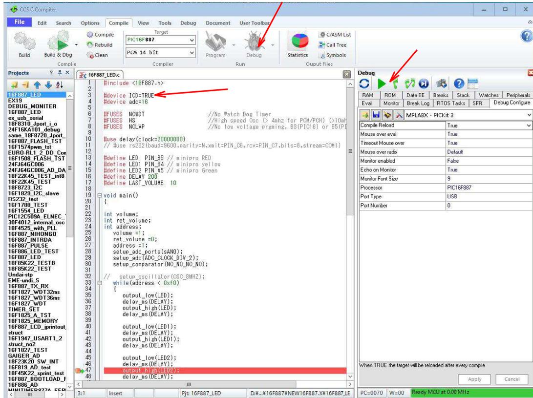
ボードのスタンドアロン動作のためには忘れずに ICD=TRUE をコメントアウトしてコンパイルしてご使用ください。
